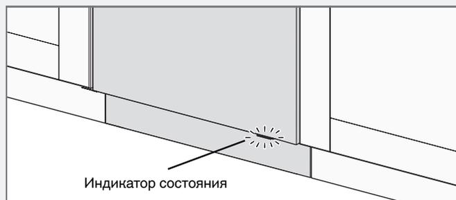
У светового индикатора состояния в нижней части машины 3 цветовых режима.
