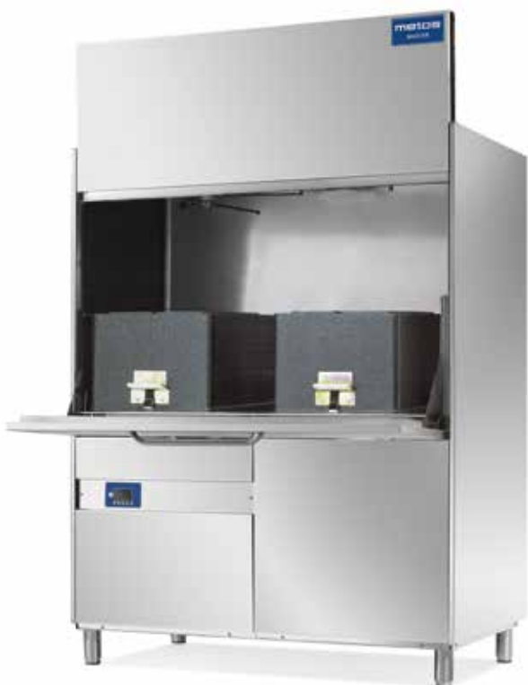
Модель Metos Master KP 402E Plus. Разделенная пополам дверца образует рабочий стол. Высота впускного проема 810 мм. Дверцы машины надежно изолированы.
