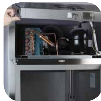
В моделях combi два конденсаторных блока, в других моделях – один..
