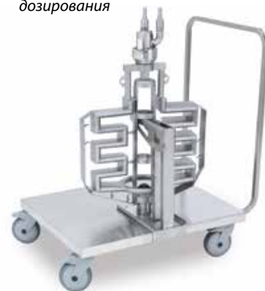
Тележка MWT для мойки рабочего инструмента миксера
