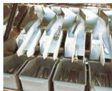
Автоматический сортировщик укладывает приборы в коробки, после чего коробки отправляются на раздачу.
