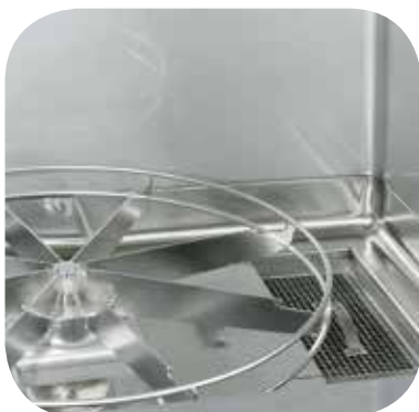
Поворотный стол для круглых моющих кассет и фильтров.
