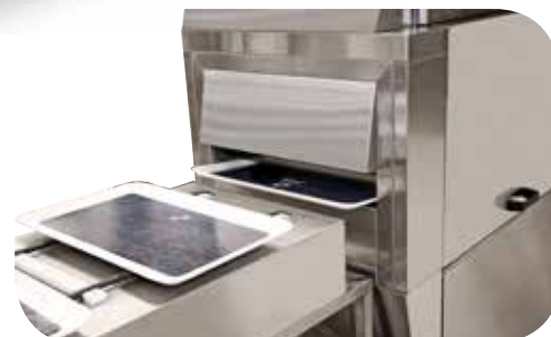
Транспортировочная система подает подносы в машину длинной стороной вперед.
