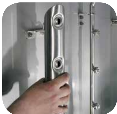
Съемные моющие рычаги для облегчения чистки.
