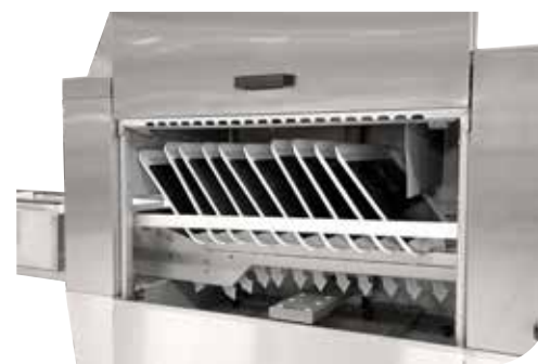
Для достижения оптимального результата мойка и сушка подносов осуществляется в вертикальном положении.
