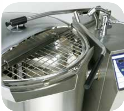
Съемная решетка обеспечивает непрерывное наблюдение за приготовляемой пищей и добавление ингредиентов, воды и специй при работающем миксере.
