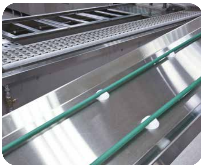
Круглая лента, с концевым выключателем, дополнительной откидной рабочей поверхностью, резиновой противоударной защитой и вращающейся рабочей поверхностью.
