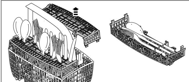
Крышку корзины для столовых приборов можно снять и использовать, например, в качестве дополнительной корзины, разместив в ее в верхней корзине (см. выше).
