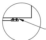
\* Если высота установки составляет 860-861 мм, отвинтите стопорные гайки.
