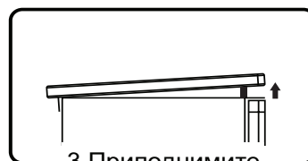
3. Приподнимите верхнюю крышку спереди и установите упор.
