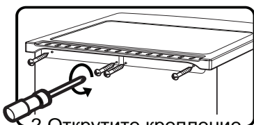
2. Открутите крепление верхней крышки с задней стороны прибора.
