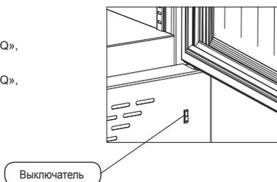
В шкафах: «Бирюса 460KDNQ»; «Бирюса 460KDN»; 520KDNQ»; «Бирюса 520KDN»; «Бирюса 700KDNQ»; «Бирюса 770KDN»; «Бирюса 770KDNQ»; включение светильника осуществляется автоматически при открытии двери. При закрытии двери свет гаснет.
