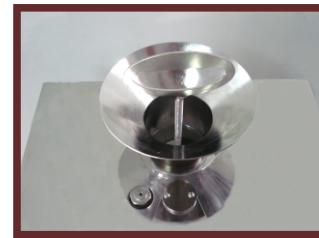
Die Schnecke verfügt über Rechts-Links-Lauf und kann zur einfachen und zügigen Reinigung leicht ausgebaut werden. Die Maschine verfügt über ein Flussstopp-Pedal.
