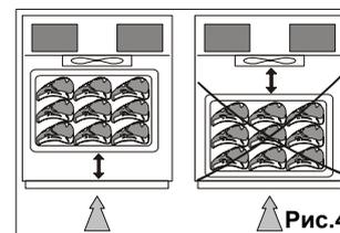
Если аппарат не занят полностью предусмотренными лотками, разместите их равномерным образом. (рис.5)
