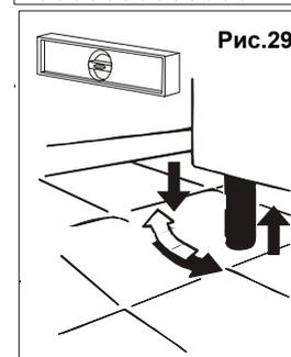
**Внимание:** Если установка оборудования не отрегулирована их функционирование и утечка конденсата могут быть рискованными.
