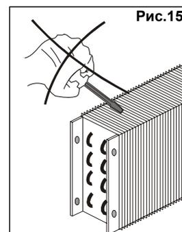
Эта операция производится минимум один раз в 30 дней и выполняться неметаллическими щетками, таким образом, чтобы смести всю пыль с решеток конденсатора.
