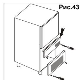
Используя специальное оборудование удалить крышку и добраться до составных частей (рис.44).
