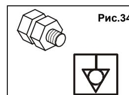
Проводник заземления должен быть правильно соединен с действующей установкой заземления. (рис.35)
