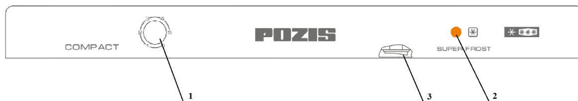
Рис.2 Схема расположения приборов управления и сигнализации 1 – ручка терморегулятора; 2 – индикаторная лампа; 3 – переключатель;
