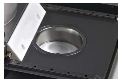
Надежная гигиеничная машина; тесто не остается вакуумной камере, что делает машины SLIM простыми в очистке и идеальными для быстрой смены типов теста.
