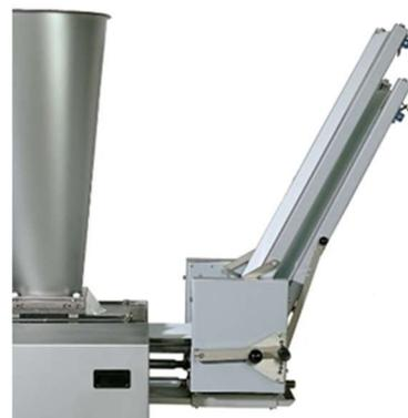
Оptionальный сдвоенный разгрузочный конвейер для длительного формования и транспортировки порций теста с макс. высотой 165 см.
