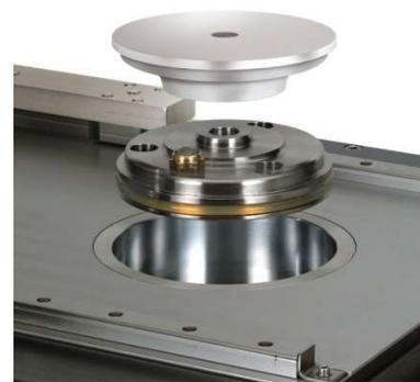
Точная вакуумная система для деления теста без сдавливания для любых типов теста.
