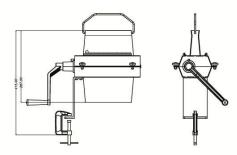
Закрепить тендеризатор на столе, отрегулировать решетку по толщине кусков. Опустить мясо в горловину. При вращении рукоятки, мясо начнет медленно продвигаться в горловину. Внимание: не толкать пальцы в отверстие горловины!
