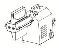
Подсоединить тендеризатор к электромясорубке Хакка TC с разьемом на 8# или к другой машине с универсальным разъемом на 12# (рис. 1). Включить мясорубку, отрегулировать решетку по толщине кусков мяса. Опустить мясо в горловину. Ножи размягчат все жилы.
