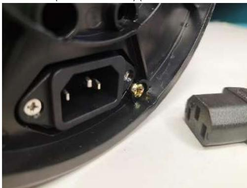
Питание подключается с помощью шнура в разъём внизу оборудовании. Оборудование обязательно должно быть заземлено, а в цепь включены устройства, фиксирующие утечку тока.
