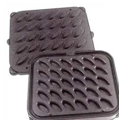
Форма «Е» 30 маленьких овальных формочек d=34x68 мм, Н=15 мм толщина стенки 3 мм, толщина доньшка 5 мм
