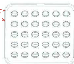
Форма 5 30 форм «орешек» 38x32мм Н=16мм толщина доньшка и стенок 3мм
