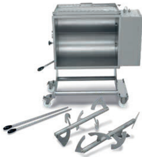
Pala facilmente rimovibile Rmovable mixing arms
