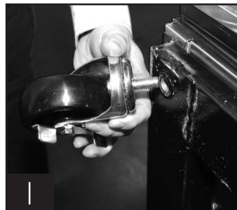
1 Ввернуть 4 винта колесной шаровой опоры снизу в элементы рамы.
