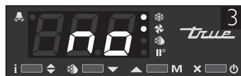
Рис. 3: Если появился символ «no», контроллер разблокирован.
