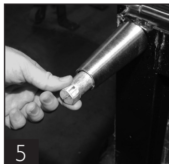
5 Конструкция кончика ножки позволяет производить регулировку шкафа по горизонтали.
