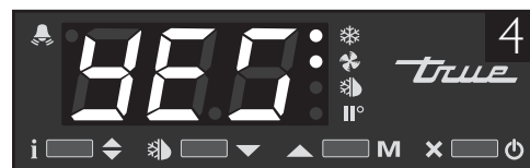
Рис. 4: Если появился символ «yes», контроллер заблокирован.
