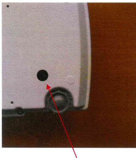
Рисунок 2 – Схема пломбировки весов
