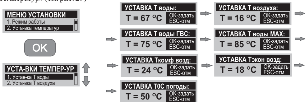
Рисунок 29. Установка температурных параметров.
