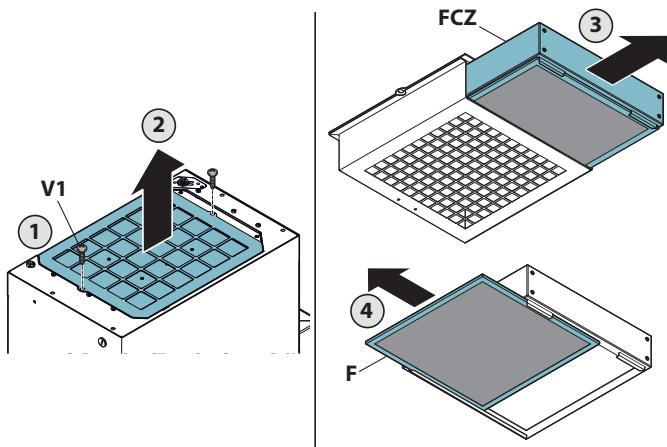
**Угольный цеолитный фильтр и нижний фильтр-улавливатель пыли нельзя мыть.**
