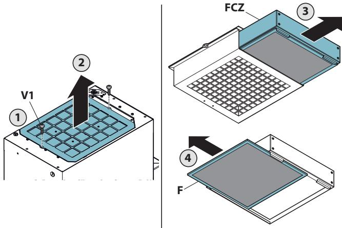
**Il filtro carbone-zeolite e il filtro anti polvere inferiore non possono essere lavati.**
