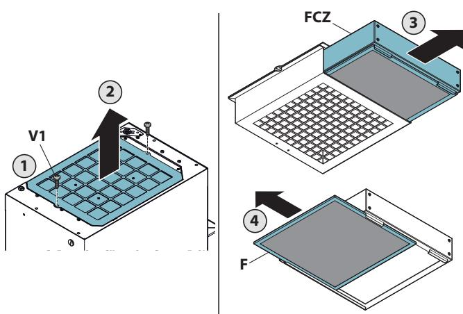
**Czyszczenie na mokro filtra węglowo-zeolitowego i filtra przeciwkurzowego nie jest dozwolone.**
