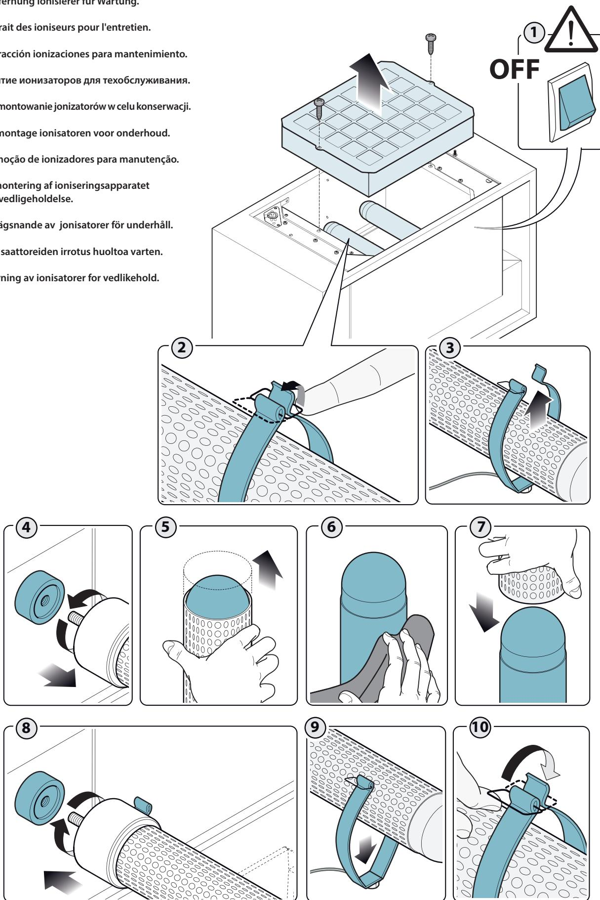
IT - Rimozione ionizzatori per manutenzione.
