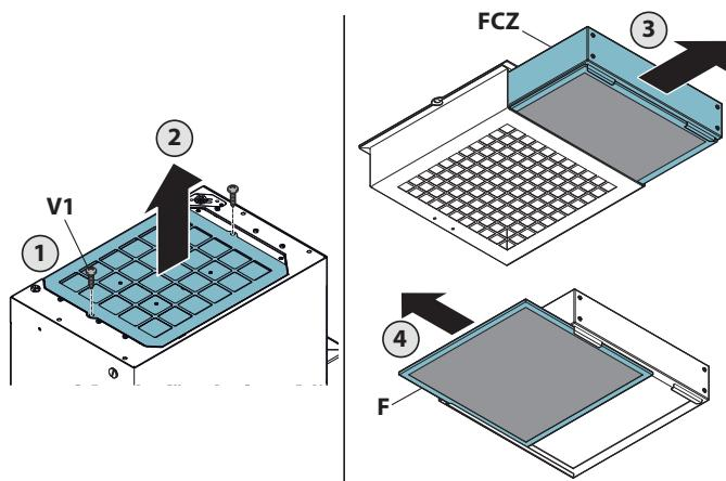
**Karbon/zeolitt-filteret og det nedre støvfiltret kan ikke vaskes.**
