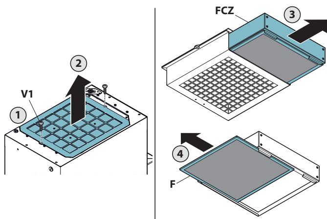
**Zeolit-kulfilteret og støvfilteret kan ikke vaskes.**
