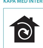
I denna version passeras luften genom filtren i kol/zeolit och det joniserande systemet E.ION för att renas och återvinna i miljön. Kontrollera att filtren i kol/zeolit har monterats på kåpan. Om så inte skulle vara fallet, placera dem så som anges i instruktionerna för montering.
