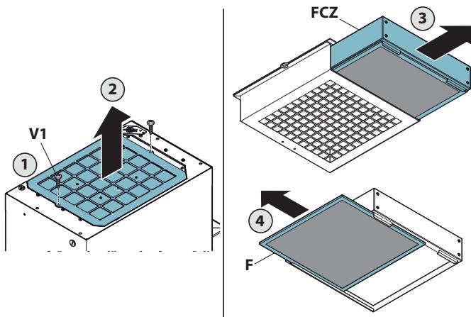
**Le filtre en charbon-zéolite et le filtre anti-poussière inférieur ne peuvent pas être lavés.**
