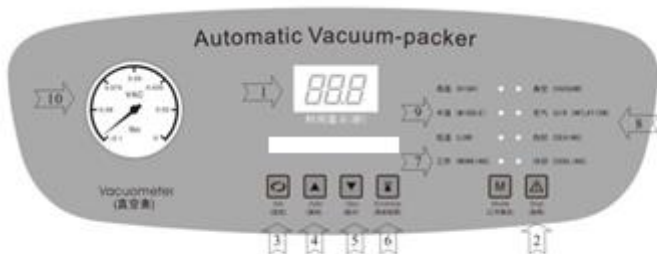
Рис. 6 Электронная панель управления оборудования.
