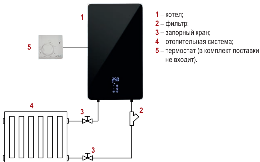
Рисунок 19 - Подключение термостата (в комплект поставки не входит)
