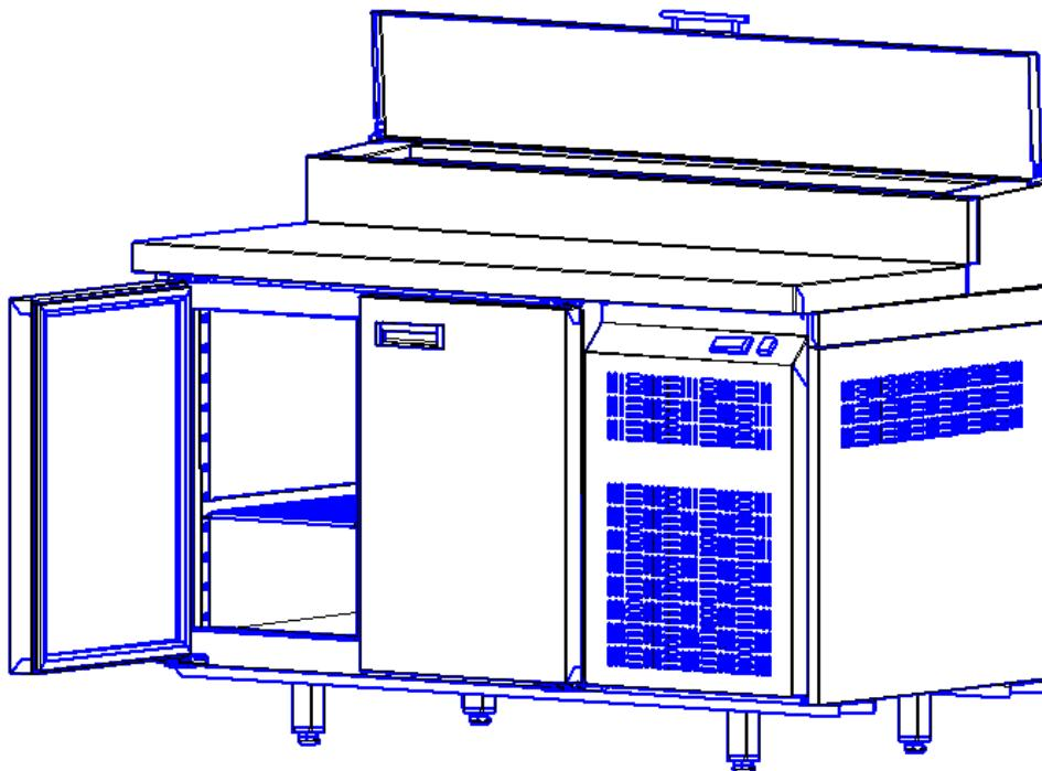
При включении кнопки «Работа» на цифровом индикаторе контроллера выводится текущее значение температуры внутри стола холодильного. Компрессор начинает работать только после истечения времени, указанного в таблице 3. Одновременно с включением компрессора на цифровом индикаторе загорается знак «—» (охлаждение).
