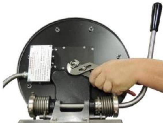
**Шаг 2:** Ослабить мешалку в сборе. Обстучать сварную планку мешалки резиновой киянкой, поворачивая ее в направлении ПО ЧАСОВОЙ СТРЕЛКЕ, после чего открутить и снять мешалку.
