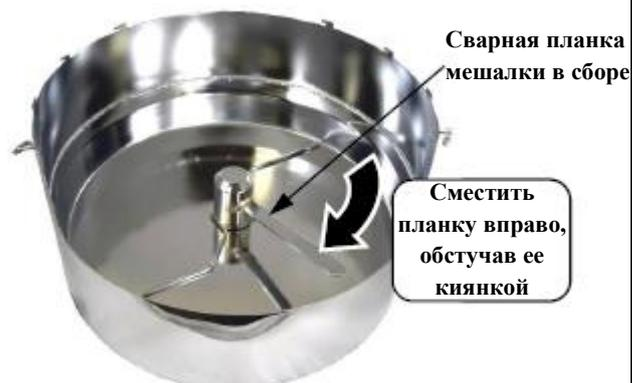
**Шаг 3:** Оставить обойму уплотнения и набивочный шнур в собранном виде. Для удаления остатков продукта можно протереть ТОЛЬКО поверхности ступицы в сборе, а для удаления стружки и остатков картона – внутренние поверхности ступицы мешалки.
