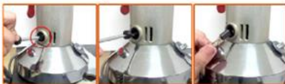
Замена угольной щетки
