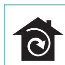
În ceea ce privește acest model, aerul trece prin filtrele de cărbune pentru a fi purificat iar apoi este reînțors în bucătărie. Asigurați-vă că filtrele de carbon activ sunt instalate în hotă, dacă nu, instalați-le aşa cum este indicat în instrucțiunile privind instalare filtrelor.
