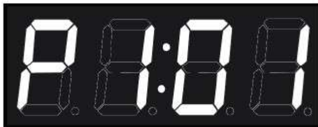
Пример отображение параметра «P1» и его значения, равного 1
