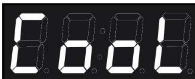
Индикация, свидетельствующая о необходимости охлаждения камеры
