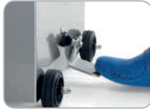
Azionamento spinta pistone Piston pushing up
