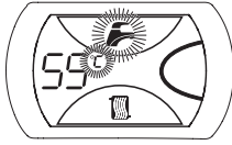
Рис. 5 Индикация настройки температуры ГВС
