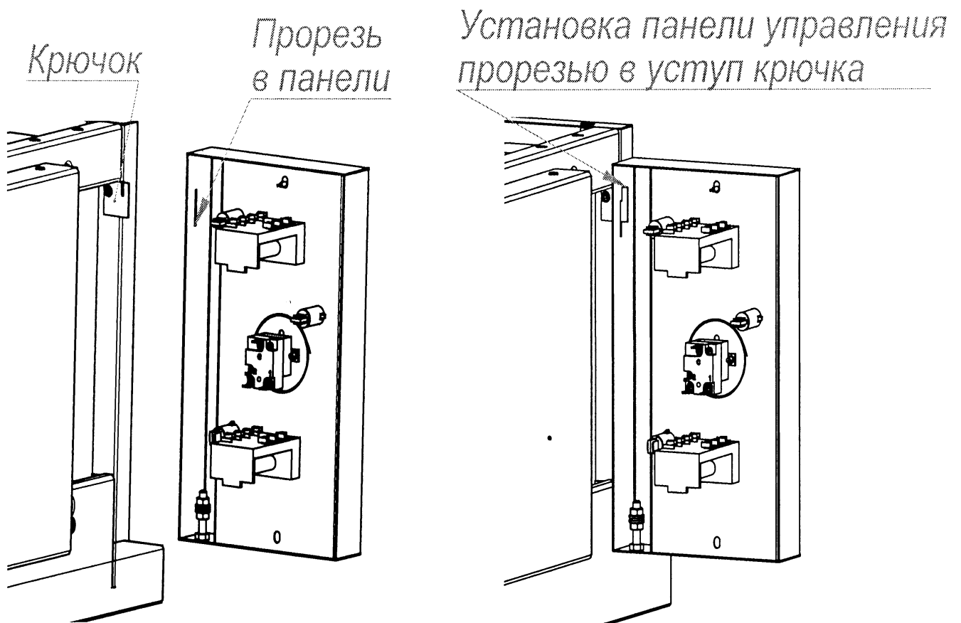
Рис. 5. Технологическое окно для замены контрпетли.
