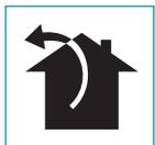
På denne version ledes røg og dampe fra køkkenet ud i det fri gennem et udledningsrør. Til dette formål skal udgangen på emhætten være forbundet til et eksternt udtag via en rørføring.
