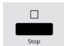
Нажимайте кнопку **Stop (Стоп)** в течение трех секунд, пока не услышите долгий звуковой сигнал и не загорится индикатор функции. В заблокированном состоянии все кнопки дезактивированы.
