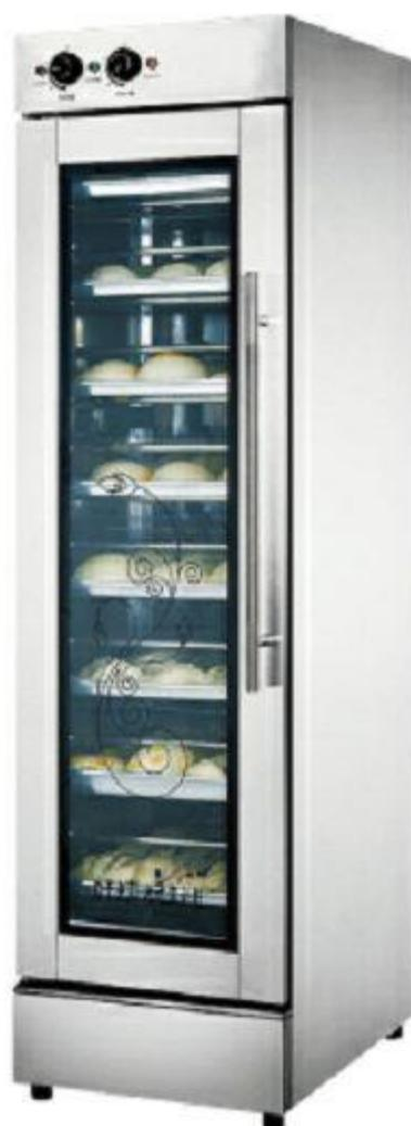
Расстоечные шкафы ERGO серии FJ, разработаны для хлебопекарного производства и расстойки дрожжевого теста закваска среды: Относительная влажность в рабочей камере составляет 80%-85% и температура 35-40 градусов Цельсия. Расстоечный шкаф FJ может быть использован для расстойки дрожжевого теста, а так же для поддержания влажности и температуры готовой продукции. Расстоечные шкафы серии FJ имеют эргономичный дизайн и отличаются простотой эксплуатации и надежностью.
