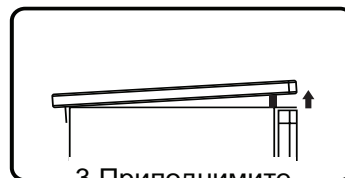
3. Приподнимите верхнюю крышку спереди и установите упор.
