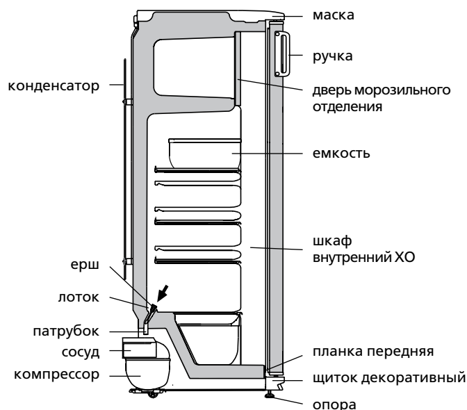
Рисунок 4 – Схема слива талой воды из ХО
