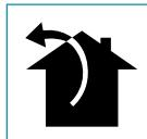
Dans cette version, les fumées et les vapeurs sont envoyées vers l'extérieur à travers un tuyau d'évacuation. À cette fin, le raccord de sortie de la hotte doit être raccordé par un tuyau à une sortie extérieure.
