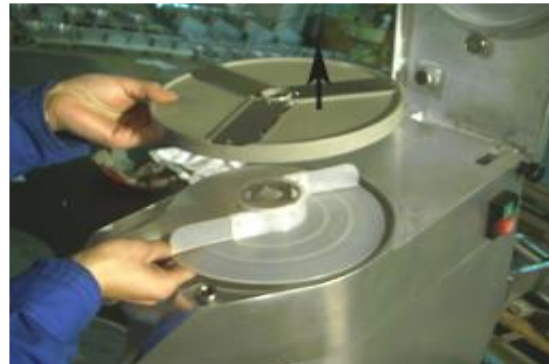
Установка режущей пластины (4)
