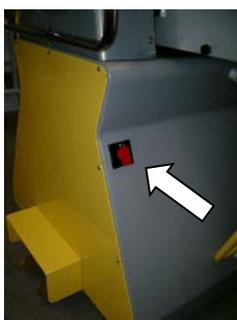
Установите общий выключатель красного цвета (рис. 4а) в положение 1.
