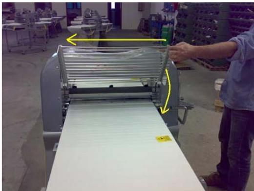
Защитные панели снабжены автоматической блокировкой при открытии.
