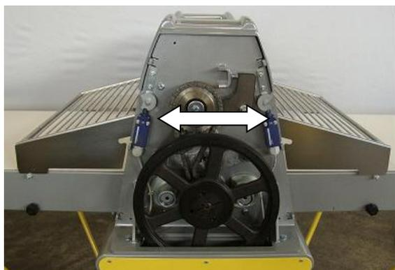
Для остановки машины достаточно малейшего повышения уровня защиты; немедленной остановке машины способствуют 2 позиционных сенсора, размещенные внутри машины, на фото обозначенные стрелкой (рис. 3).
