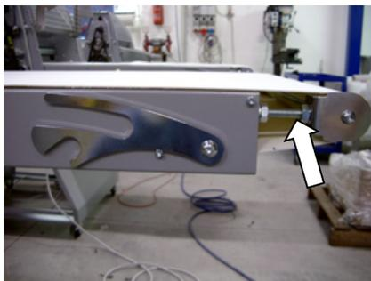
Натяжение лент регулируется гайкой, обозначенной стрелкой.
