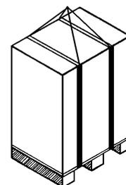
Машину для перевозки следует упаковать в деревянную клеть или картонную коробку, размещенную на поддоне. *Рис. 1*
