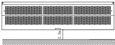
3.4 Если ширина входа в помещение превышает размер агрегата, рекомендуется установить несколько воздушных завес над выходом с расстоянием 20-40 мм между ними.
