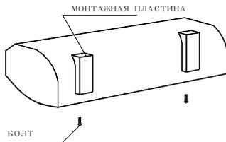
4.3.2 Зафиксируйте потолочное крепление, см. рисунок ниже:
