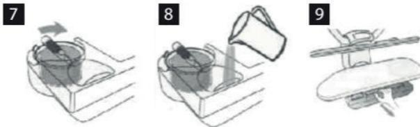
3. Поверните картридж направо до упора (рис. 7). Заполните бак водопроводной или дистиллированной водой (рис. 8). Установите бак для воды в его отсек (рис. 9). При необходимости бак можно заполнять водой в процессе глажения.
