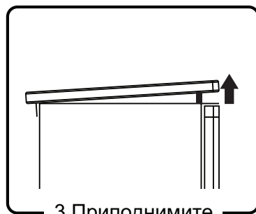
3. Приподнимите верхнюю крышку спереди и установите упор.
