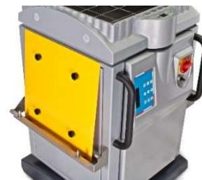
Фиксаторы формовочных решеток, прессовочные или верхние пластины с обеих сторон машины.
