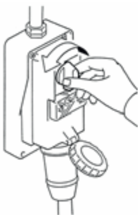
Рис. 6.2.1. - Выключатель цепи электропитания переведен в позицию (O - OFF)
