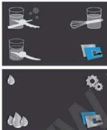
Слева на экране находятся две опции для цикла очистки. Выберите верхний значок для полоскания или нижний для полного цикла очистки.
