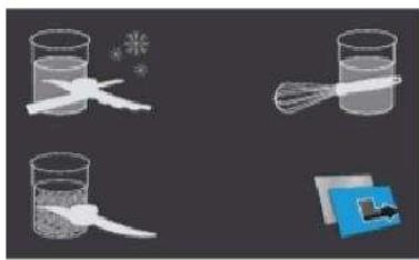
При включении комбайна при помощи кнопки ВКЛ/ВЫКЛ на дисплее появится логотип PACOJET в течение нескольких секунд. Сразу же после этого загрузится главное меню, на котором будут отображаться значки 3-ёх режимов обработки и значок для доступа к очистке и настройкам функций комбайна. Из главного меню PACOJET 2 может быть настроен/запрограммирован на необходимые процессы.
