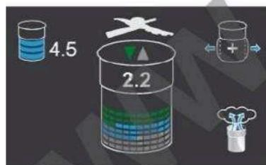
На экране показаны запрограммированные детали порционирования до пакотизации и, кроме того, в ходе пакотизации наполненность стакана и ход выполнения задачи.
