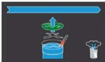
После успешного завершения цикла полоскания и автоматического сброса давления, на экране появится сообщение о том, что теперь можно безопасно снять защитный стакан. Выньте защитный стакан из комбайна и вылейте воду.
