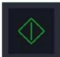
Кнопка СТАРТ используется для того, чтобы начать цикл обработки. До начала цикла обработки пакотизирующий стакан должен быть вставлен в защитный наружный стакан и установлен на место, а машина должна находиться в режиме готовности.
