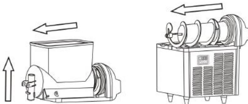
5. Вытащите шпильку и снимите ручку выпускного крана. Помойте все элементы с помощью мыльного раствора.
