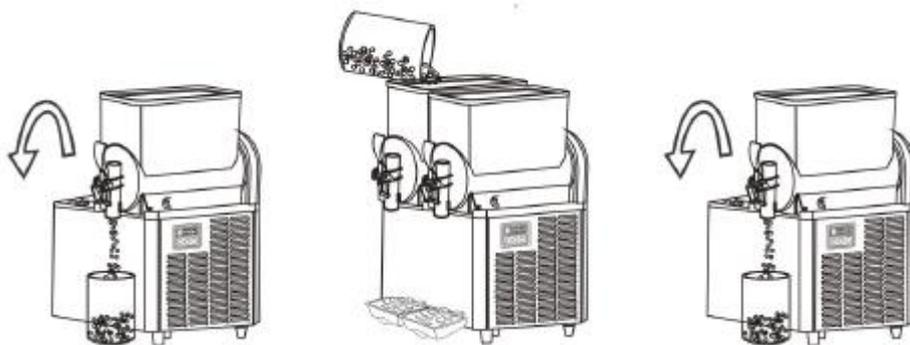
4. Чтобы снять бункер, сначала потяните его вверх, затем в сторону выпускного крана. Далее снимите элементы перемешивающего устройства.
