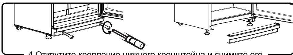
4. Открутите крепление нижнего кронштейна и снимите его.
