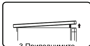
3. Приподнимите верхнюю крышку спереди и установите упор.
