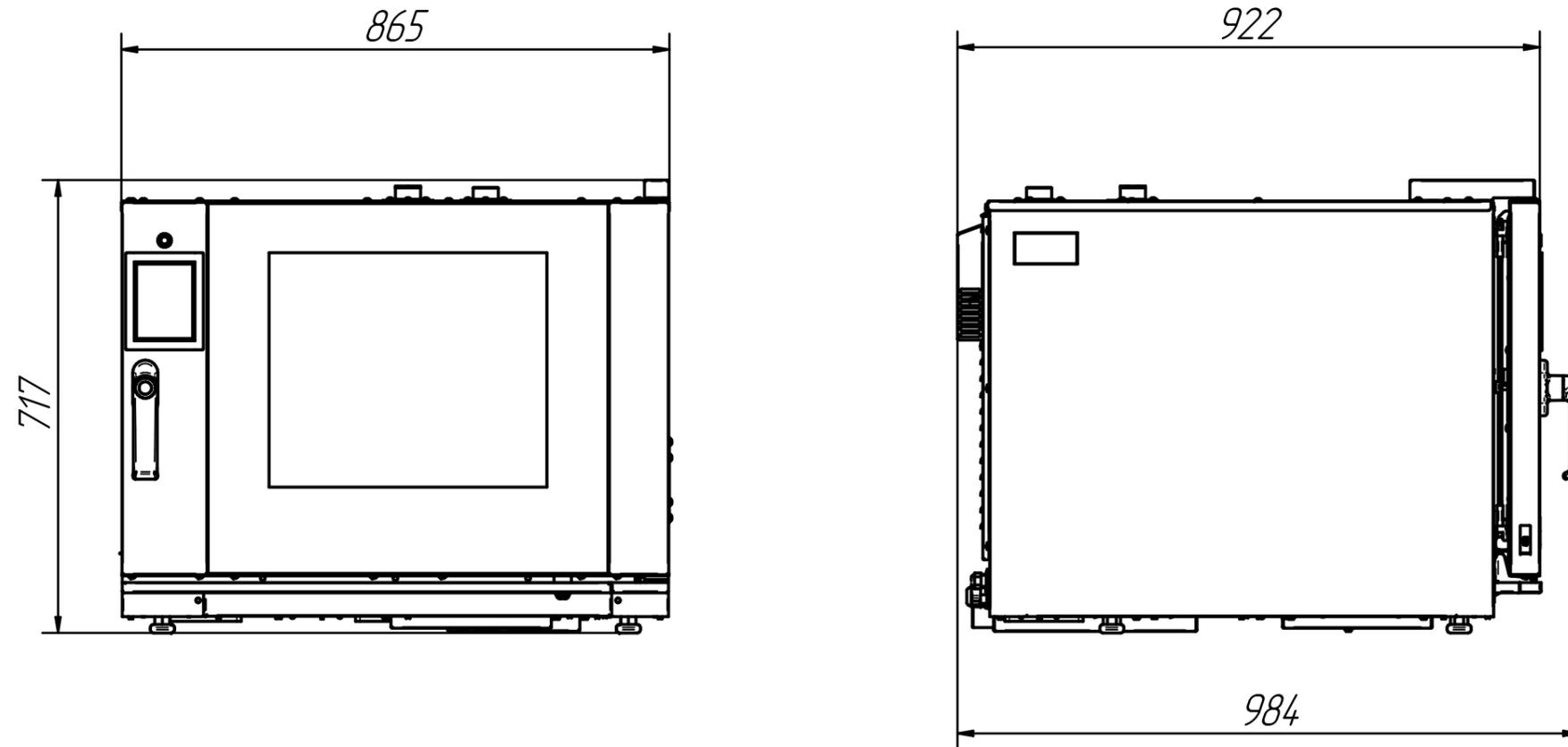
Конвекционная печь электрическая КЭП-5ПП предназначена для приготовления пищи на предприятиях общественного питания. Управление осуществляется через электронную панель управления (Touch панель), расположенную на двери печи. По программе возможно задать до десяти этапов приготовления. В конструкции двери используется ручка с механизмом байонет. Дверь имеет возможность фиксации своего положения в открытом состоянии.
