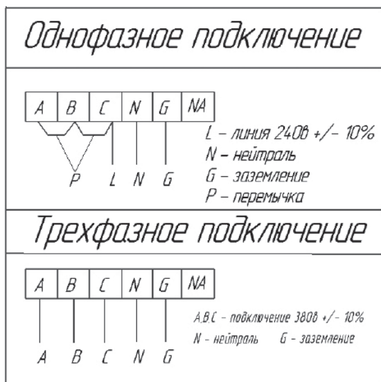
Рис. 4. Схемы подключения электрического котла к электросети.
