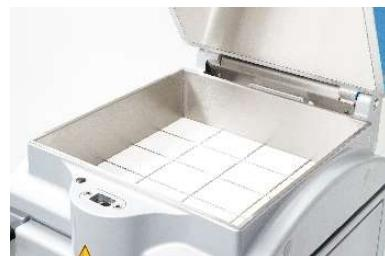
Высококлассный делительный нож из нержавеющей стали для деления теста на куски от 120 до 3340 г.
