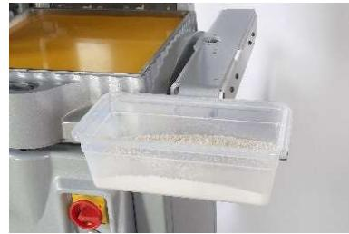
Удобный съемный лоток для муки с крышкой можно установить в одном из 4-х мест на машине.
