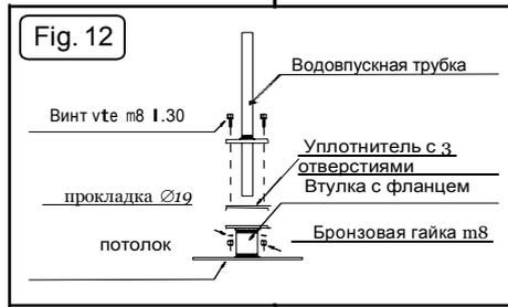
Установите блок впуска воды на втулку с фланцем (**Pos.5**) как показано на **Рис. 12**.
